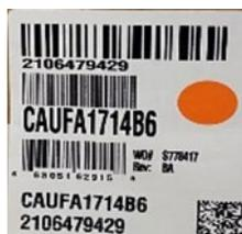
Si ce point orange est observé, cela indique que la bobine a déjà été modifiée et ne nécessite aucune autre action.
